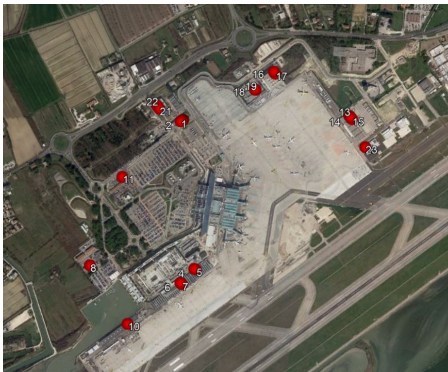
Figura 33. Posizione dei camini delle Centrali Termiche
