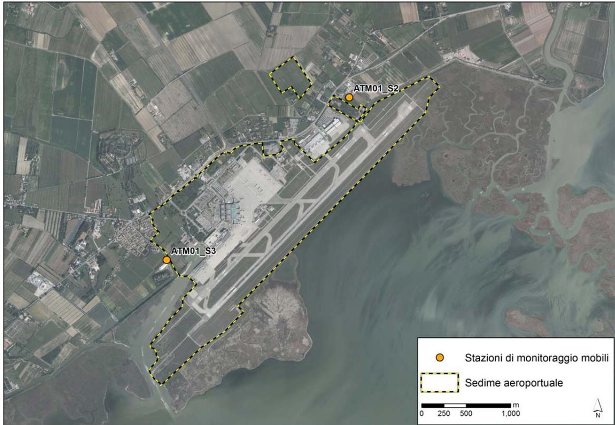
**Figura 3-5 Posizionamento dei punti di monitoraggio con mezzi mobili.**
