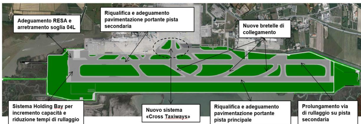
Interventi di “Riqualifica ed adeguamento normativo delle infrastrutture di volo – Lotto 2”
