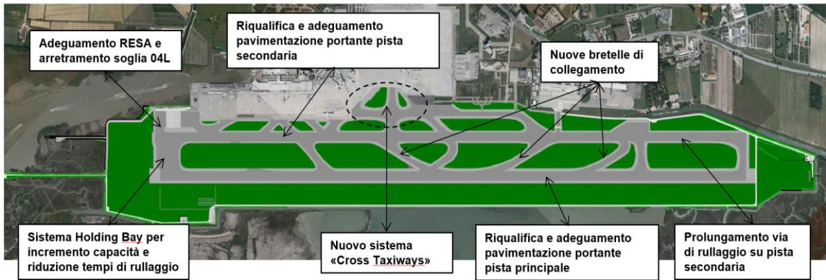
Interventi di "Riqualifica ed adeguamento normativo delle infrastrutture di volo – Lotto 2"
